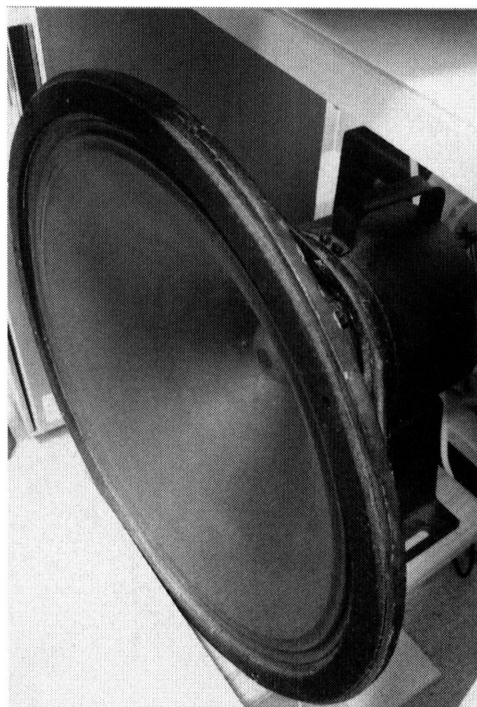
写真⑬ 46センチロンドンウェスタン製 スピーカー
