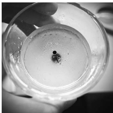
写真2 油層の上で玉になっている水性インク
