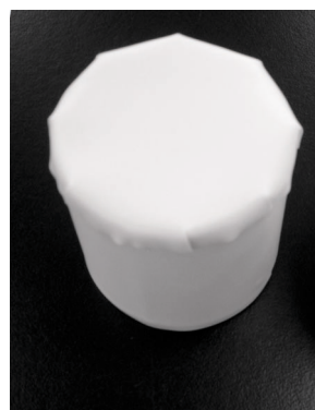
図3 図2の合口薬膏壺の周囲を白色フィルムで完全に覆う。最上部（合口薬膏壺の底部）に、白色フィルムを円形にして蓋状のものを作り隙間が出来ないように周囲を固定した。
