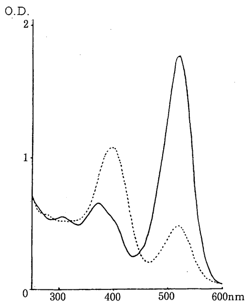
14図 赤色色素水溶液の吸収スペクトル ——水溶液調製直後に測定 .....7日間冷蔵(3 ± 2°C)後に測定
