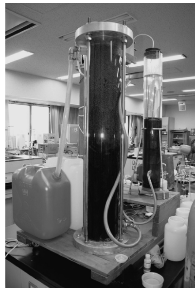
写真3 試作された家庭排水浄化システム 手前の太いタワー：微生物膜バイオリアクター、奥の細いタワー：油分吸着部
